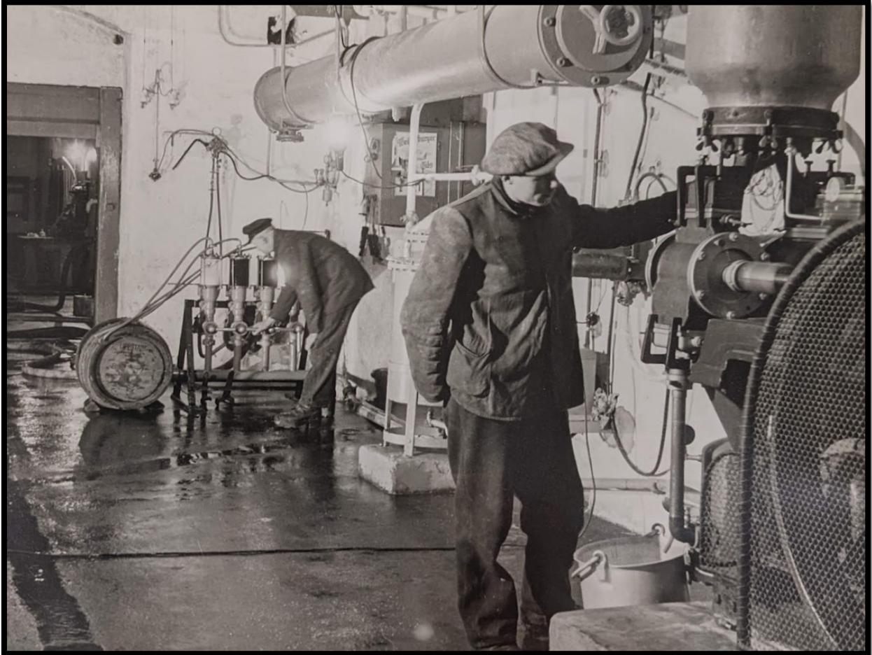
Hier werden die neuen Alufässer befüllt. Sie lösten die Holzfässer zum Ende der 1960er ab. Die Abfüllanlage wurde nur an die neuen Fässer angepasst
